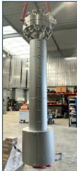
ADELINE test section SE-IT V2 test device
